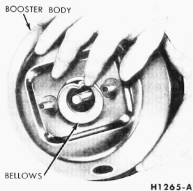
FIG. 27—Bellows-to-Booster Body Engagement
